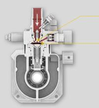
Клапан изготовлен из износостойкого карбида металла Мембрана изготовлена из полиамида, устойчивого к растворителям
